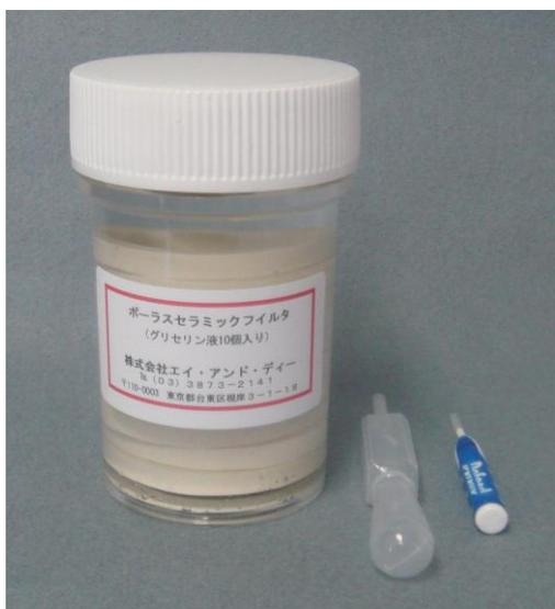
10個のセラミックフィルタがグリセリン液容器に収められています。
